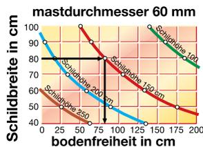
**Lesebeispiel mastdurchmesser 60 mm (links):** Bei einer Schildbreite von 80 cm und einer Schildhöhe von 150 cm, beträgt die max. Bodenfreiheit 80 cm.
