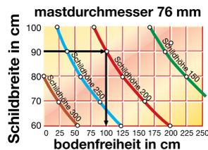
**Lesebeispiel mastdurchmesser 76 mm (rechts):** Bei einer Schildbreite von 90 cm und einer Schildhöhe von 200 cm, beträgt die max. Bodenfreiheit 100 cm.
